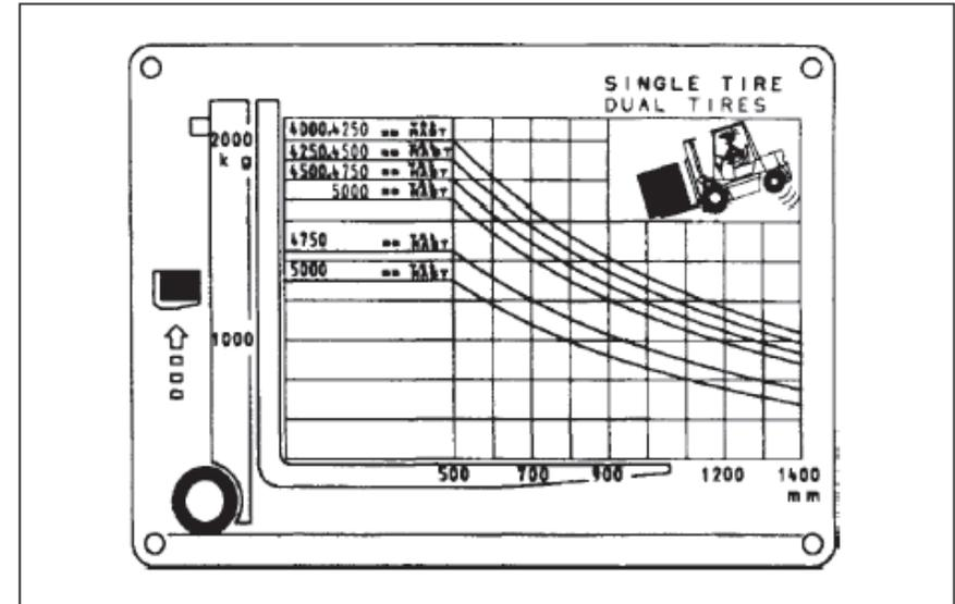
Базовый центр нагрузки — это расстояние от передней поверхности вилок до центра тяжести груза. На приведенной выше диаграмме показано соотношение между базовым центром нагрузки и массой груза, допустимой для 2-тонного погрузчика. Эта диаграмма называется диаграммой нагрузки и прикрепляется к погрузчику.
