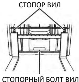
Убедитесь, что стопоры вилок правильно зафиксированы, стопорный болт вилок в середине каретки не поврежден, вилок не погнуты и не имеют трещин.
