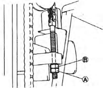
Поднимите вилы на 50 мм от поверхности земли или пола и убедитесь, что правая и левая подъемные цепи имеют одинаковое натяжение. Если натяжение неравномерное, отрегулируйте его с помощью анкерного болта цепи. После регулировки надежно затяните контргайку.
