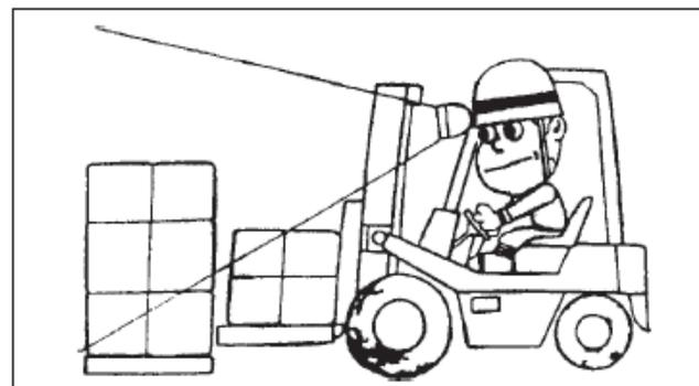
Безопасная эксплуатация требует хорошо освещенных маршрутов движения, чтобы пешеходы и препятствия были хорошо видны. Используйте фары, задние фонари, напольные фонари или другие осветительные приборы по мере необходимости.
