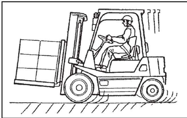
Надлежащее использование погрузчика заключается в транспортировке груза, который размещен на поддоне и уложен в соответствии с предписанным ограничением по высоте.
