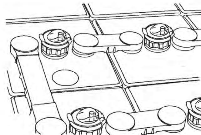
Проверьте уровень электролита в аккумуляторе. Загляните в пробку аккумулятора, чтобы убедиться, что отметка уровня видна.
