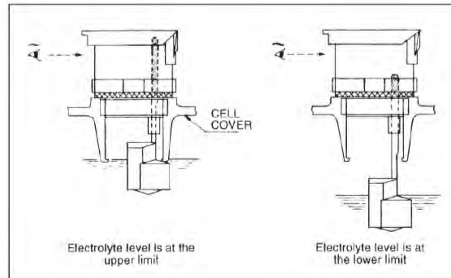
Проверьте наличие красного стержня поплавка в пробке ячейки, чтобы убедиться, что уровень электролита находится на верхней границе.
