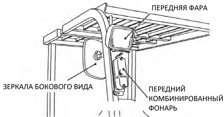
Проверьте рассеиватели фар и комбинированных фонарей (габаритные фонари и указатели поворота) на предмет загрязнений или повреждений.
