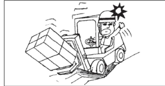
Погрузчик тяжелее, чем кажется. Например, даже пустой 2-тонный погрузчик весит почти 3,5 тонны. Кроме того, при погрузке от 80 до 90% общей массы приходится на передние колеса. Проверьте прочность ваших полов и дорог, и при необходимости укрепите их.
