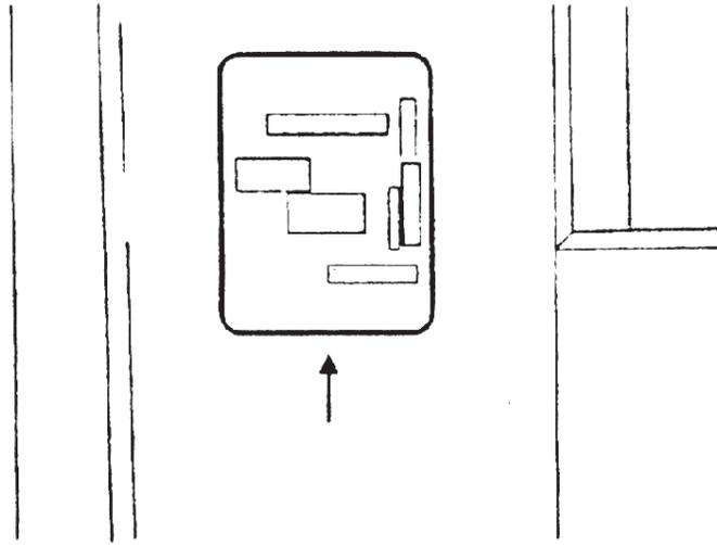
Помимо серийного номера погрузчика, серийные номера (номера узлов) основных деталей нанесены на погрузчик или указаны на табличках. На рисунке выше показана табличка с серийным номером мачты. Эти номерные знаки следует сохранять для дальнейшего использования при обслуживании.
