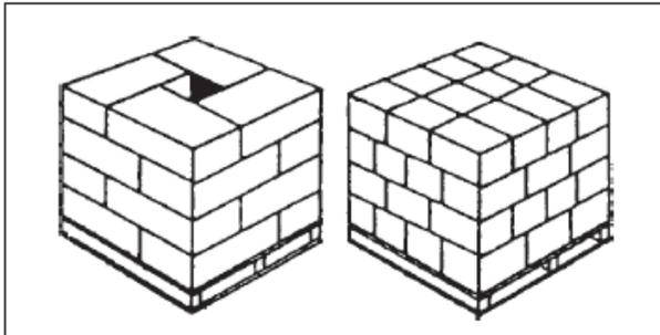
При штабелировании грузов располагайте их устойчиво, чтобы они не развалились, и убедитесь, что вес распределен равномерно. Закрепите верхний слой шнуром, обернутым как повязка на голову или подобным образом.
