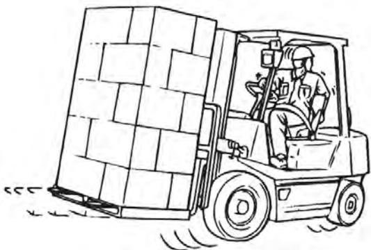
**⚠ При работе с крупногабаритными грузами используйте сигнальщика**
