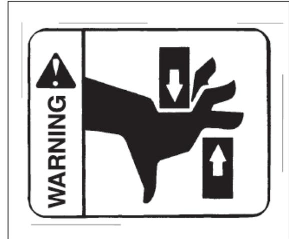
**Ф. Наклейка с предупреждением о безопасности при работе с вентилятором и длинными вращающимися частями**
