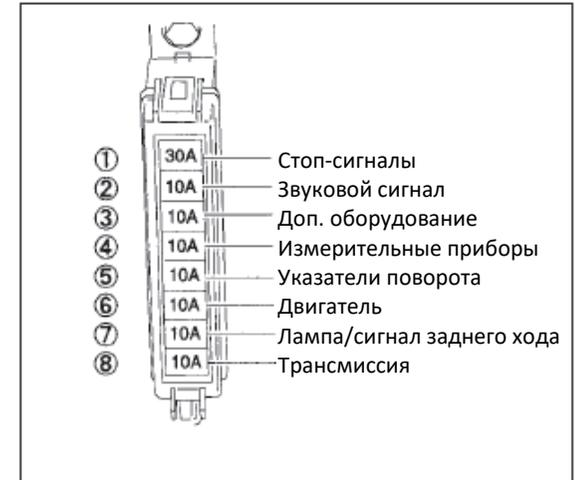
(1) - 3): Предохранители работают независимо от положения ключа зажигания.
